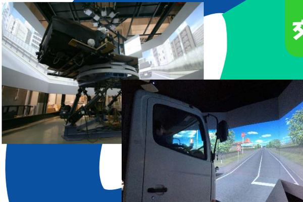
高度道路交通システム (ITS)、安全な自動車の開発、ドライバーの行動分析のための運転模擬装置があります。
